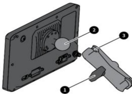
3. Setzen Sie die Aufnahme der Halterung des Bedienterminals **1** auf das Kugelgelenk **2** der Halterungsgrundplatte des Bedienterminals auf, auf die gleiche Weise wie in Schritt 2 beschrieben. Drehen Sie dann die Flügelmutter **3** im Uhrzeigersinn, um den Bedienterminal zu fixieren.
