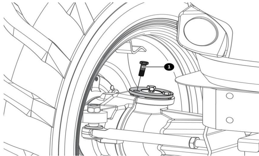
2. Montieren Sie den Neigungssensor **1** auf der Vorderachse, passen Sie den Kabelbaum an und montieren und festziehen Sie die in Schritt 1 entfernte Schraube.
