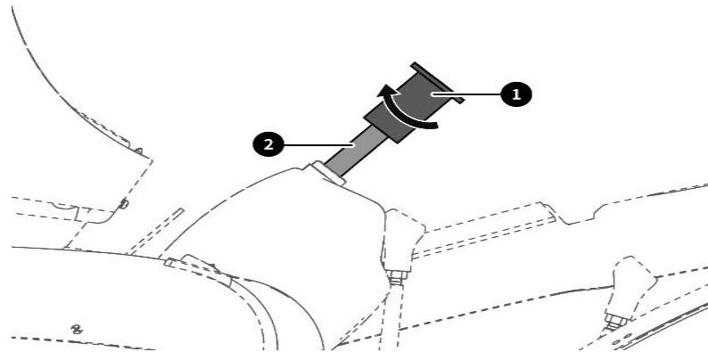
3. Entnehmen Sie die ausgewählte Keilnabe **1** der Lenksäule und setzen Sie sie in den Lenkmotor des elektrischen Lenkrads **2** ein. Befestigen Sie die Keilnabe anschließend am Motor mit sechs Sechskant-Zylinderschrauben (M4x14) **3**, M4-Federscheiben **4** und sechs M4-Tellerscheiben **5**.
