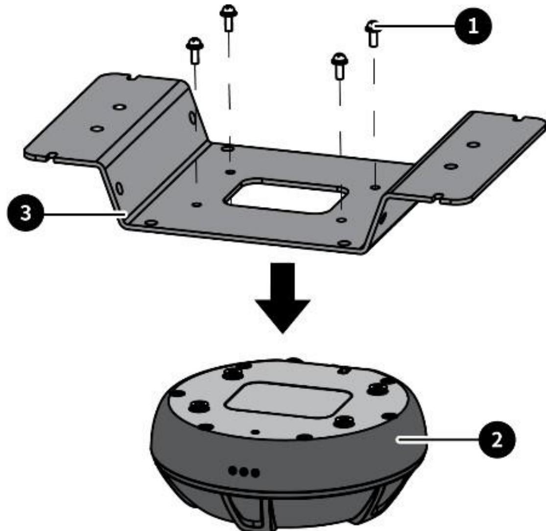
2. Installieren Sie den GNSS-Empfänger und die Halterung an der Oberseite der Maschine, wo sie fest und mit geringer Vibration sind, mit einer der folgenden Methoden: 1. selbstbohrende Schraube; 2. 3M-Sticker; und 3. selbstbohrende Schraube + 3M-Sticker.
